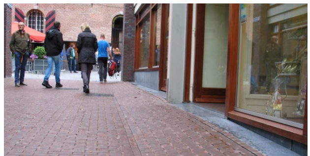
Avledning av vann på terreng. Veiprofilen beskytter butikkene mot oversvømmelse. Leidsje Rejn, Holland.
