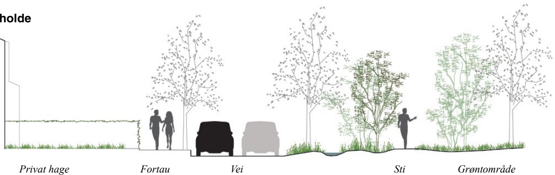
Vadi med underliggende dren med forsinket avledning til avløp. Anlegget er dimensjonert til å magasinere ekstremregn lokalt og utgjør godt 30 prosent av veiens opprinnelige bebygde areal (Rødovre, Danmark).
