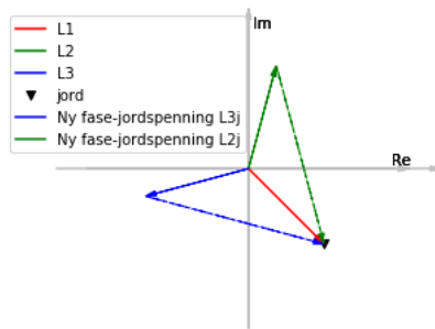
Figur 38: System med enfase jordfeil uten overgangsmotstand
