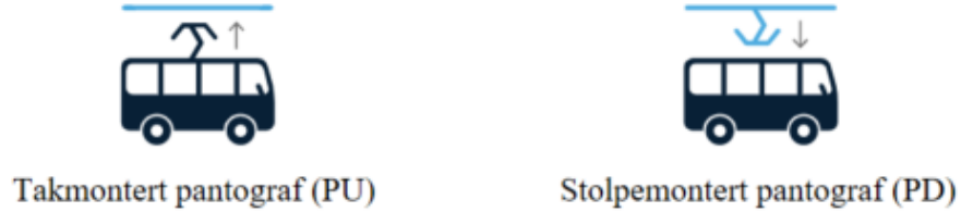
Figur 2: Illustrasjon av to pantografløsninger. Figur til venstre viser takmontert pantograf, mens figur til høyre viser stolpemontert pantograf [21].
