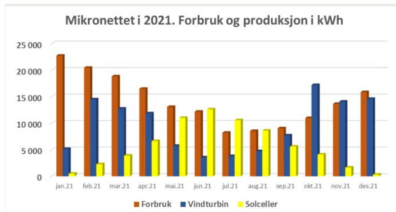
Figur 1: Viser produksjonsprofilen til vindturbinen og solcellene, og energiforbruket igjennom ett år. Hentet fra sluttrapporten for prosjektet «Mikronettipilot Byneset: Demonstrasjon av ny energi- og klimateknologi»
