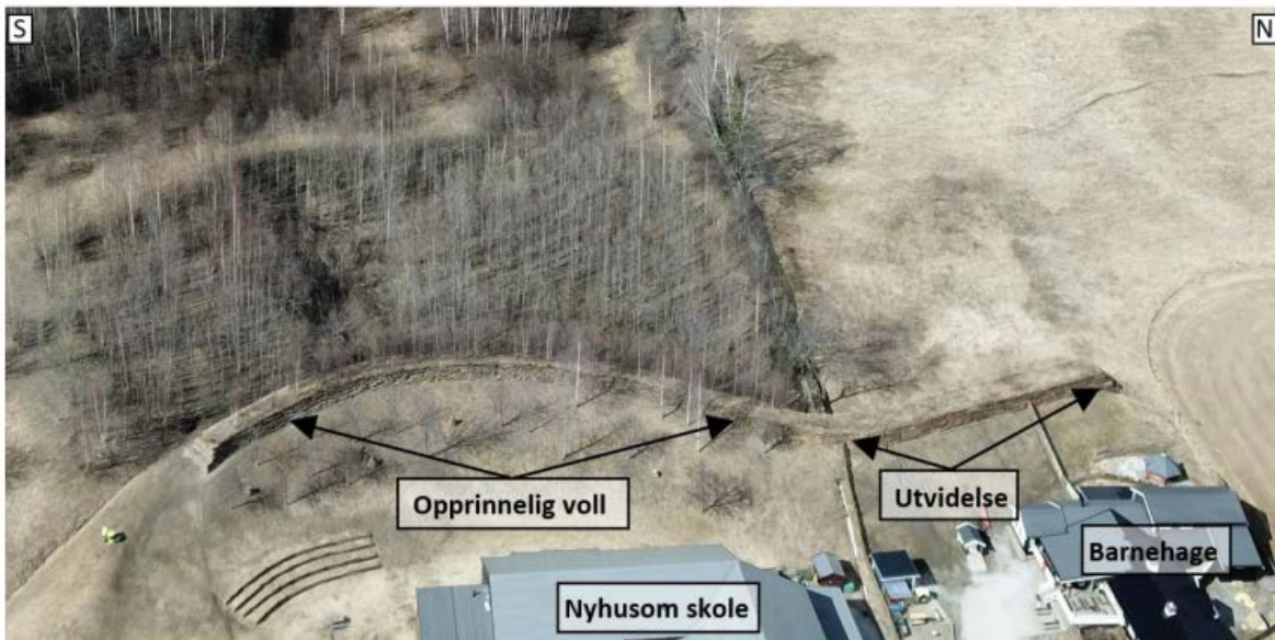
Figur 3-23. Opprinnelig voll for Nyhusom skole ble utvidet mot nord i forbindelse med bygging av barnehagebygg.
