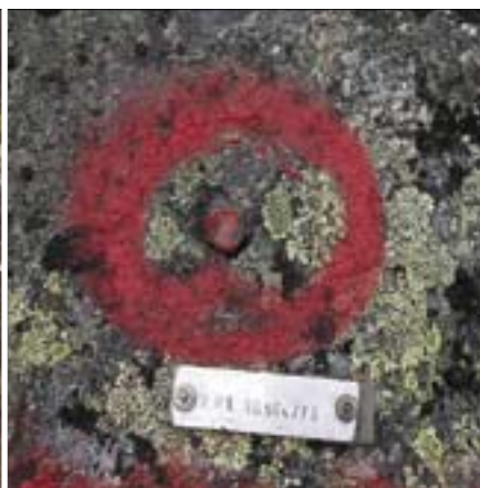
Fastmerkebolt markert med rød farge og med opplysning om høyde
