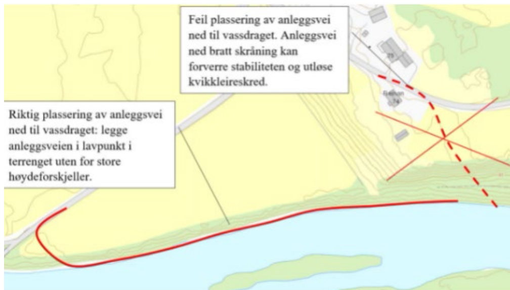
Figur 10: Eksempel som viser god og dårlig plassering av anleggsvei ned til elvebredden.
