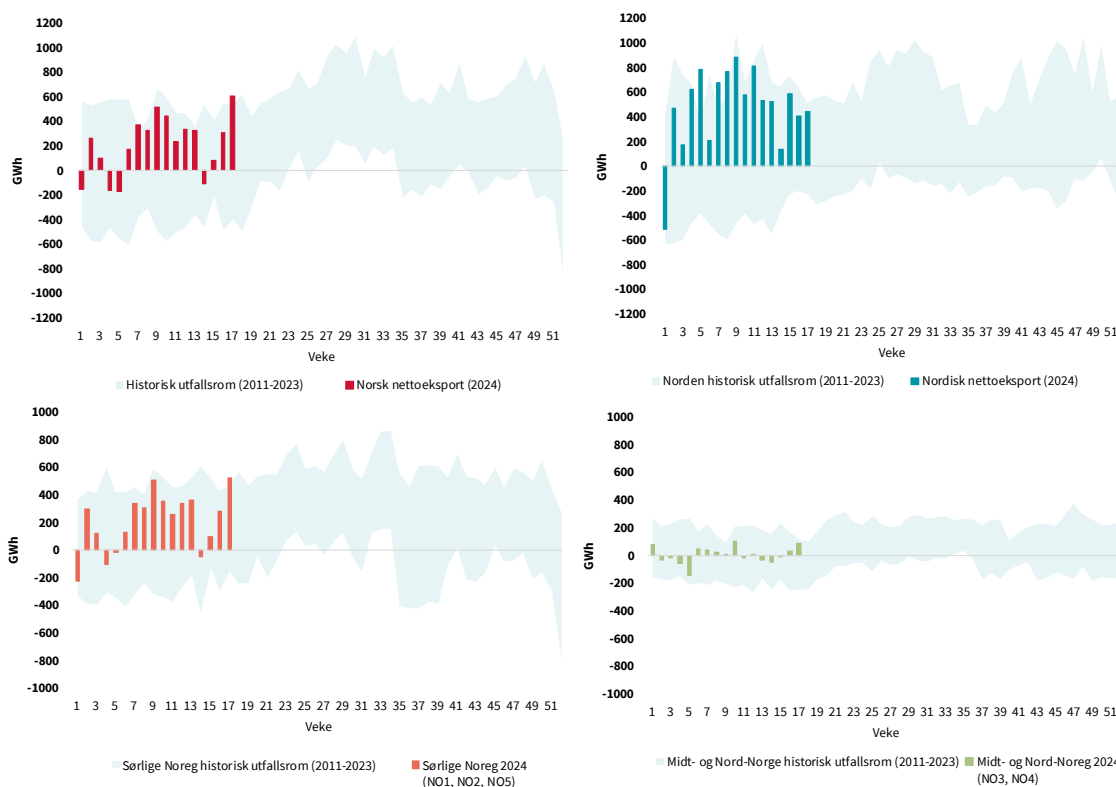
Figur 12 Nettoutveksling pr. veke for Noreg, Norden, Sørlege-Noreg (NO1, NO2, NO5) og Midt- og Nord-Noreg (NO3, NO4) i år og historisk utfallsrom. GWh. Kjelde: SKM Market Predictor
