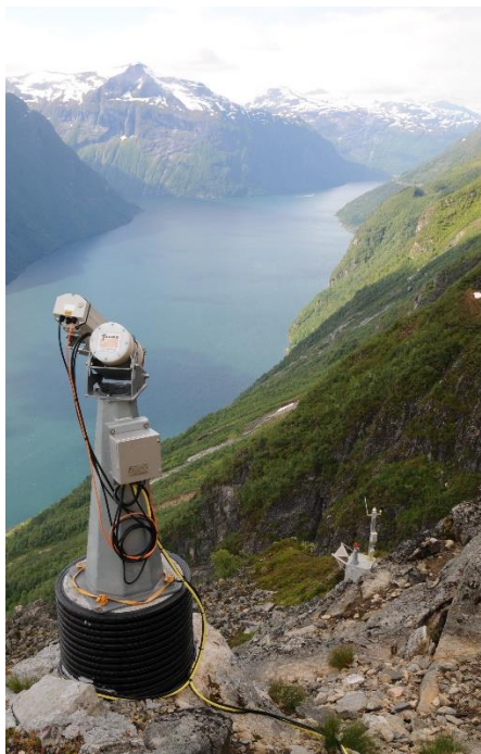
Figur 2-4: Laser, laserreflektor, mast med GPS og prisme.
