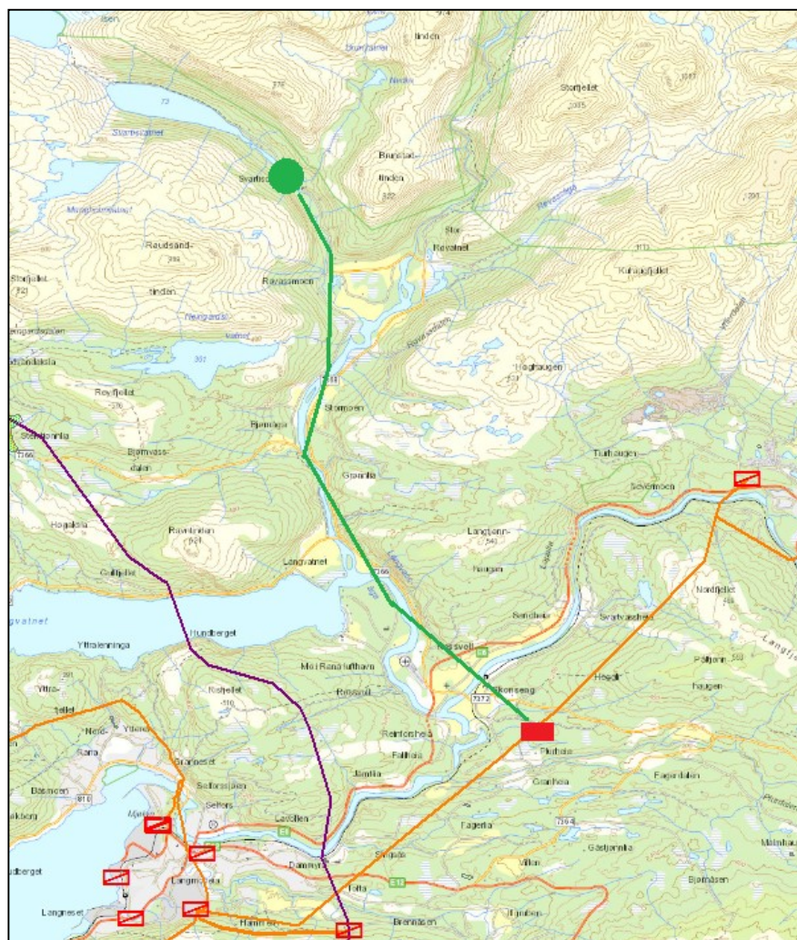
Figur 6.9: Svartidal kraftverk med produksjonsradial til Plurheia trafostasjon. (Kraftverket er vist med grønn sirkel og produksjonsradialen med grønn strek. Plurheia transformatorstasjon er vist med fylt rødt rektangel.)
