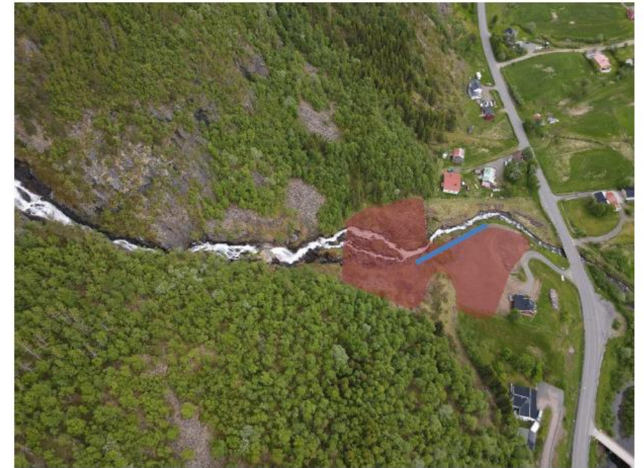
Figur 47: en liten voll ble bygd i 1965 ifølge NVE Atlas (blå linje, anleggsnummer 3461 på Figur 46). Vannet har aldri gått over ifølge en beboer. Skogen ble hogget ned nylig i det røde området
