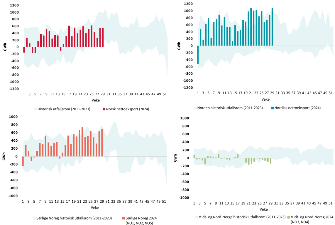
Figur 12 Nettoutveksling pr. veke for Noreg, Norden, Sørlege-Noreg (NO1, NO2, NO5) og Midt- og Nord-Noreg (NO3, NO4) i år og historisk utfallsrom. GWh. Kjelde: SKM Market Predictor
