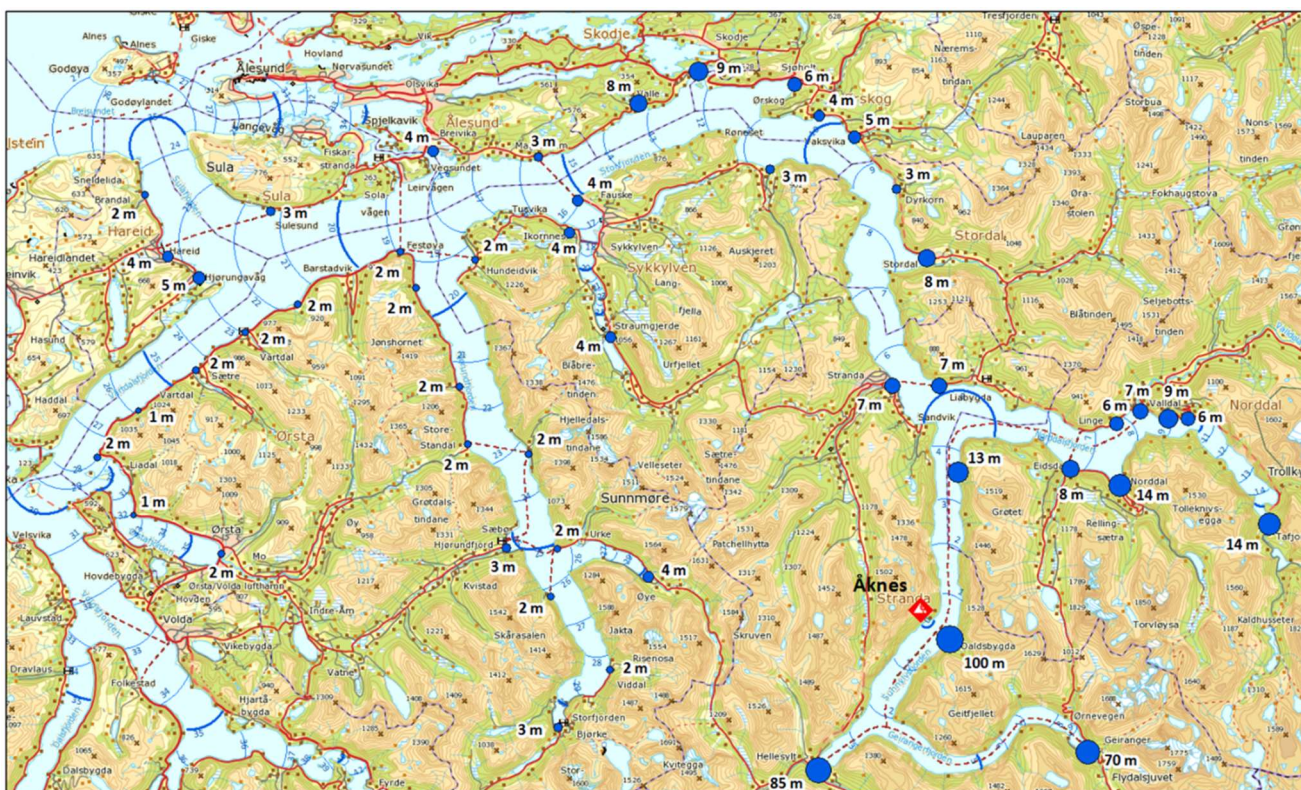
Figur 1-2: Kartet viser Åknes og estimerte bølgehøyder i Storfjordregionen for det mest alvorlige skredscenarioet. Figur lånt fra [1].
