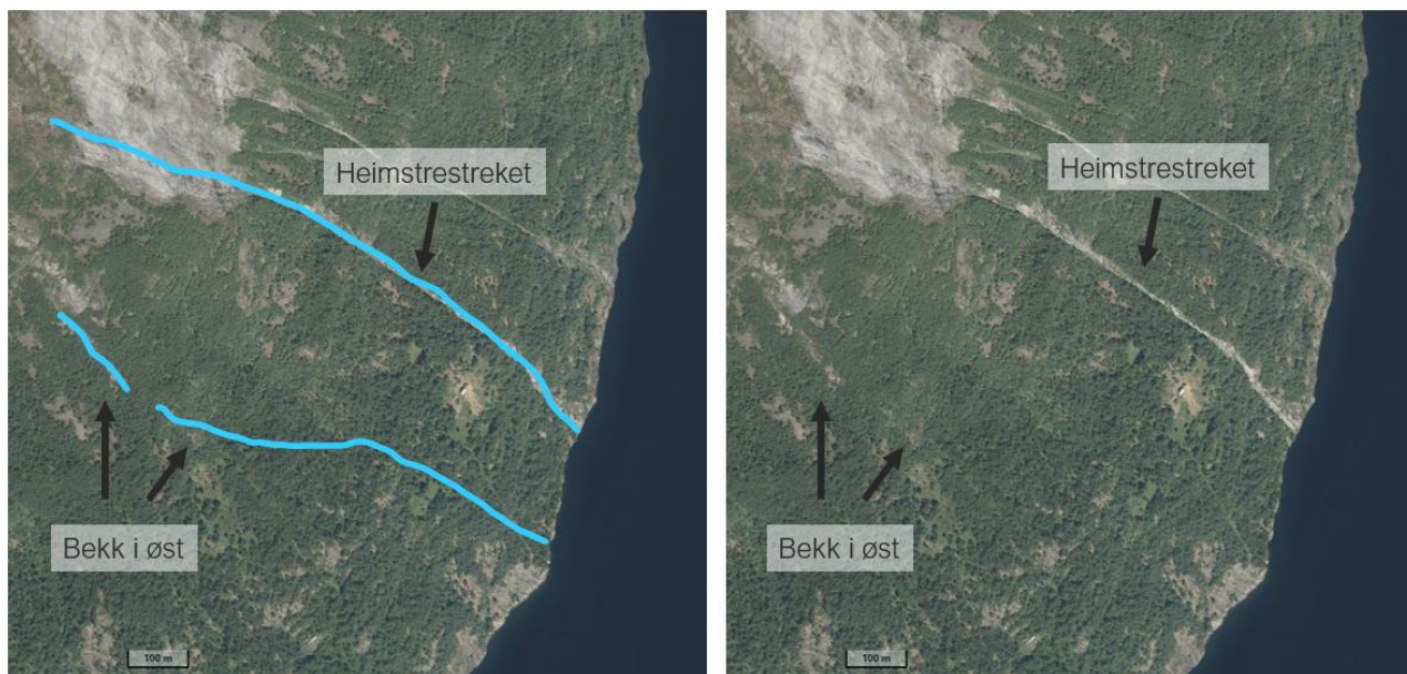
Figur 11. Bekk i øst (målpunkt til avledning per i dag) og Heimstrestreket, et alternativ for vannavledning. Flybildet til høyre viser at Heimstrestreket er betydelig nedskåret i terrenget, mens bekken i øst er ikke det.
