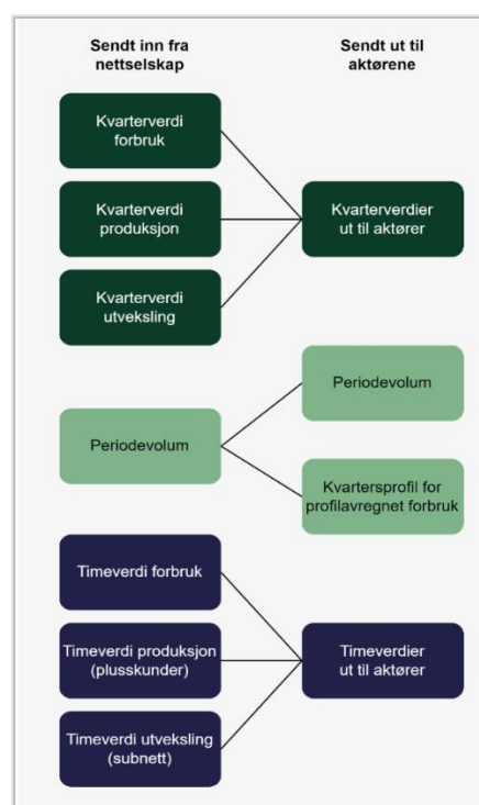
Figur 3: Måleverdier som går inn og ut av Elhubs kjerneløsning. Målepunkt med timeverdier (mørk lilla bokser) kan avskaffes om alle går over til 15 minutters registreringsfrekvens.
